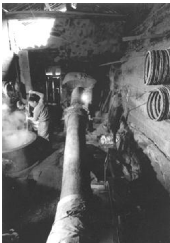
油坊室内全貌及油梁
